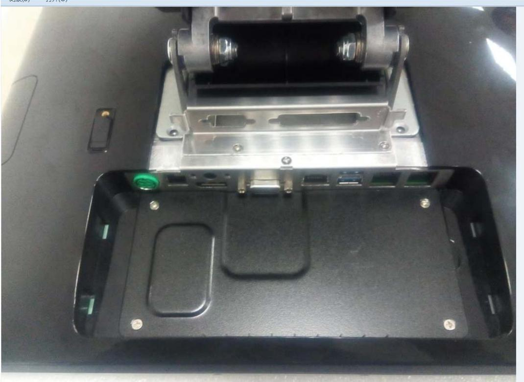
3. 拆下后盖上面的 3 个小塑料盖子 Disassembly 3 covers
