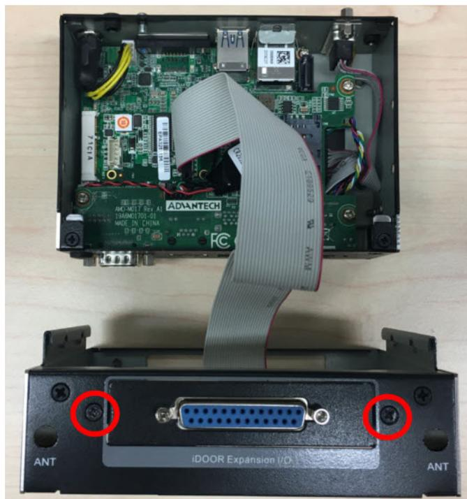
5. 将 ARK Plus 模块与系统本体组装起，并锁附系统两侧螺丝，左、右侧各 2 个螺丝。
