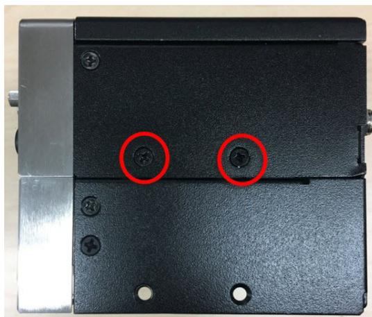
6. 将底盖固定至原位，锁回机器侧边上的 4 颗螺丝。
