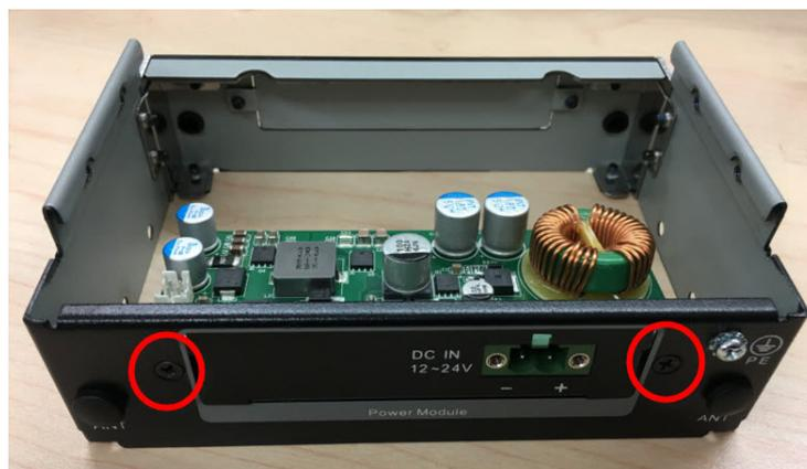
2. 卸下机器侧边上的螺丝，左、右各 2 颗，共 4 颗。
