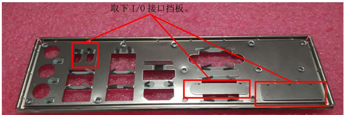
3. 将母板的 I/O 支架安装至机箱。
