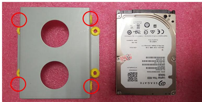
3. 然后重新装回 HDD 支架并连接 SATA HDD 电缆，安装好的 HDD 模块如下图所示（HDD 线缆位于母板的附件盒中）。
