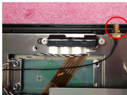
4. 将组装好的天线支架固定至机器，然后将线缆连接至无线网卡。
