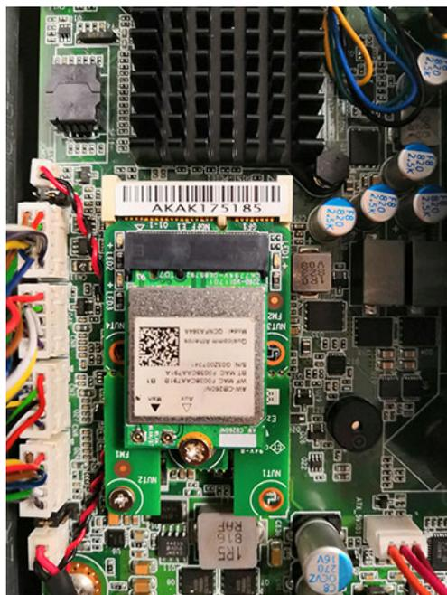
3. 将无线网卡的线缆连接至天线支架。请注意电缆头和螺母 / 垫圈的安装方向。
