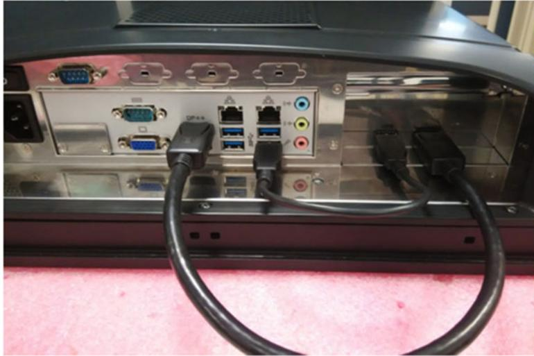
2. 移除后盖即可看到子板。然后移除电源线、扬声器线、触摸屏线、背光灯线、LVDS 线、LED 线、音频线以及 2 颗螺丝，如下所示。
