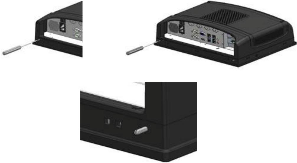
2. 将机器推至墙壁上的空口处，弹簧挂钩可把机器锁定至墙壁。
