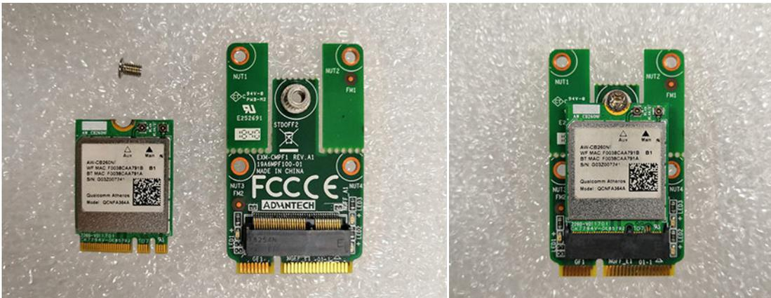
2. 将无线网卡插入正确的主板插槽，然后使用附件盒中的螺丝进行固定。
