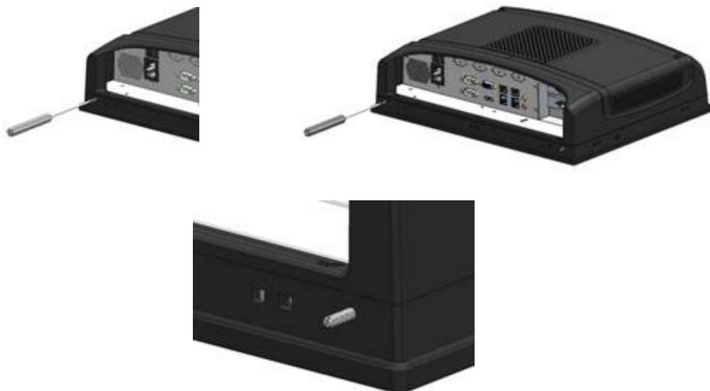
2. 將機器推至牆壁上的空口處，彈簧掛鉤可把機器鎖定至牆壁。
