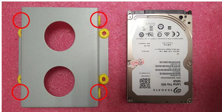
3. 然後重新裝回 HDD 支架並連接 SATA HDD 電纜，安裝好的 HDD 模組如下圖所示（HDD 線纜位於主機板的附件盒中）。
